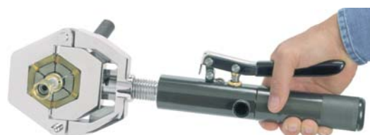
CRIMPATURA DEL RACCORDO BEADLOCK
